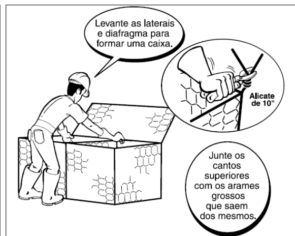
Figura 2: Posicionamento dos painéis laterais e diafragmas
